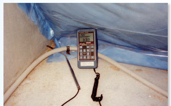
Leckageortung mit dem Anemometer
